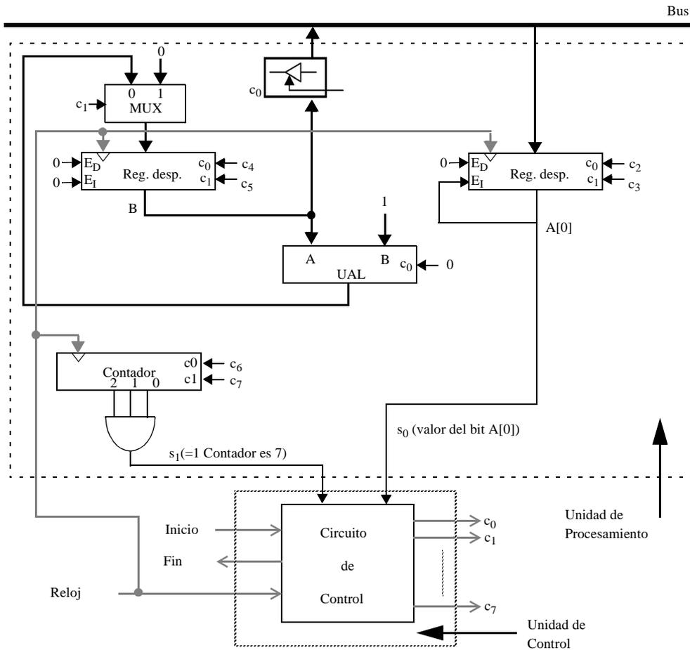
Figura 2: Diseño de la Unidad de Procesamiento
