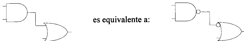
Fig. 1.2.6 "Truco" para aplicar las leyes de DeMorgan directamente sobre el esquema
